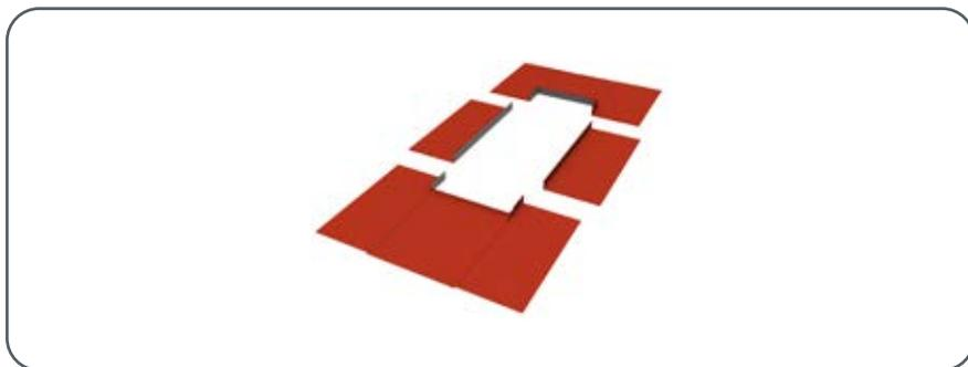
Figure 107 • Abergement de fenêtre de toit
