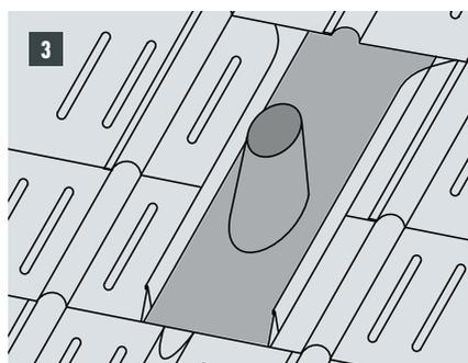
En alternative à un raccordement àagrafer, il est possible d'agrafer un embout dans une plaque de support et de poser celle-ci sur la couverture de toit. La liaison à la couverture de toit est réalisée comme pour le raccordement de ventilation àagrafer, avec des joints debout (Fig. 1 + 2).
