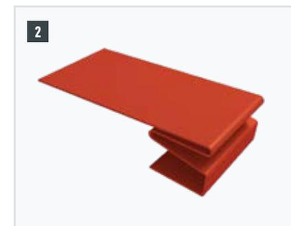
Lors de la pose de demi-losanges de fin pour losanges de toiture 29 × 29, il faut installer la bande de recouvrement fournie sur la patte de fixation du losange 29 × 29.
