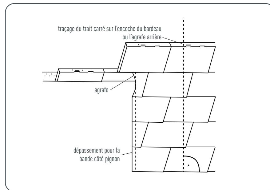
Figure 75 • Réalisation d'un décrochement de toit – Bardeaux et bardeaux DS.19
