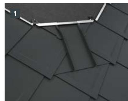
Pour le montage du raccordement de ventilation, il faut poser des demi-losanges de début et de fin pour losanges de toiture 29 × 29 ou 44 × 44.
