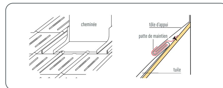
Figure 103 • Raccordement de cheminée – Tuile
