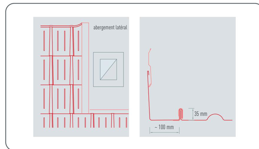
Figure 104 • Raccordement de cheminée – Tuile – Abergement latéral
