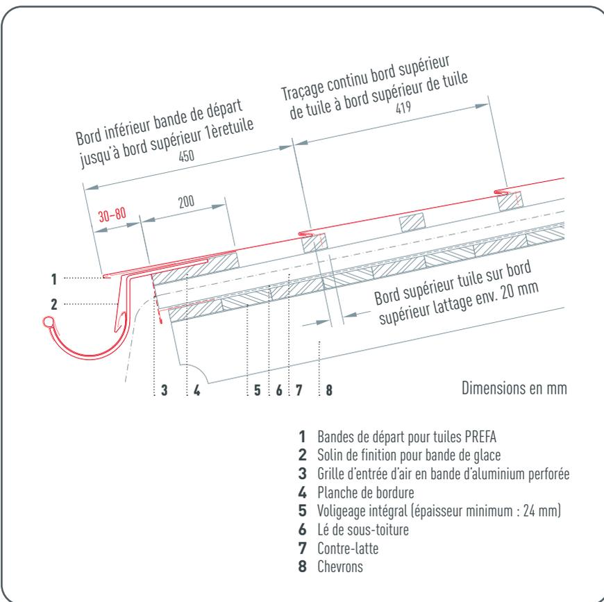
Figure 13 • Traçage pour les tuiles
