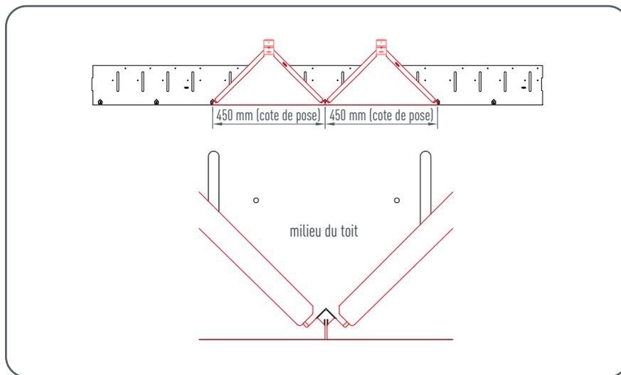
Figure 57 • Particularité pour les losanges de toiture 29 x 29
