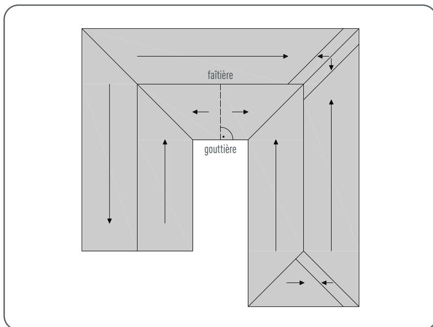
Figure 14 • Pose et sens de couverture
