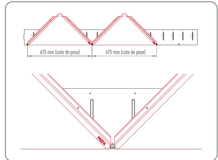
Figure 40 • Losanges de toiture PREFA 44 x 44 – Traçage
