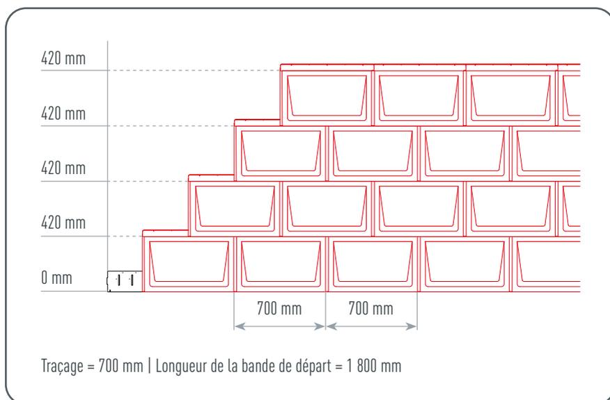
Figure 19 • Cotes de traçage pour les R.16
