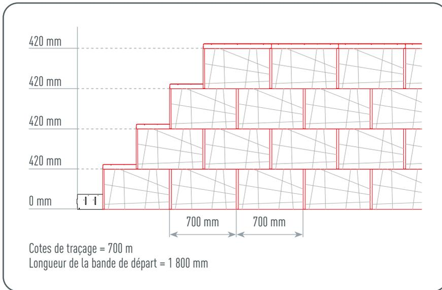
Figure 43 • Cotes de traçage pour les panneaux de toiture FX.12
