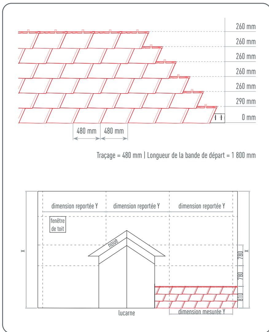
Figure 29 - Cotes de traçage pour les bardeaux DS.19
