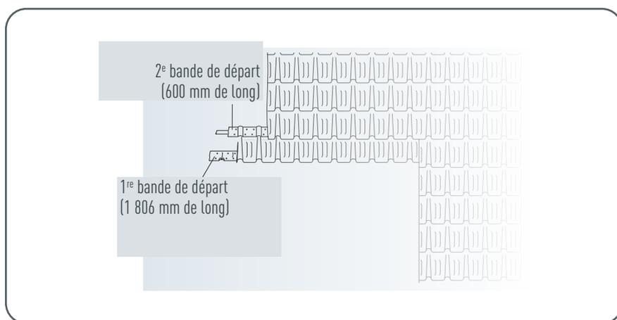
Figure 74 - Réalisation d'un décrochement de toit - Tuile
