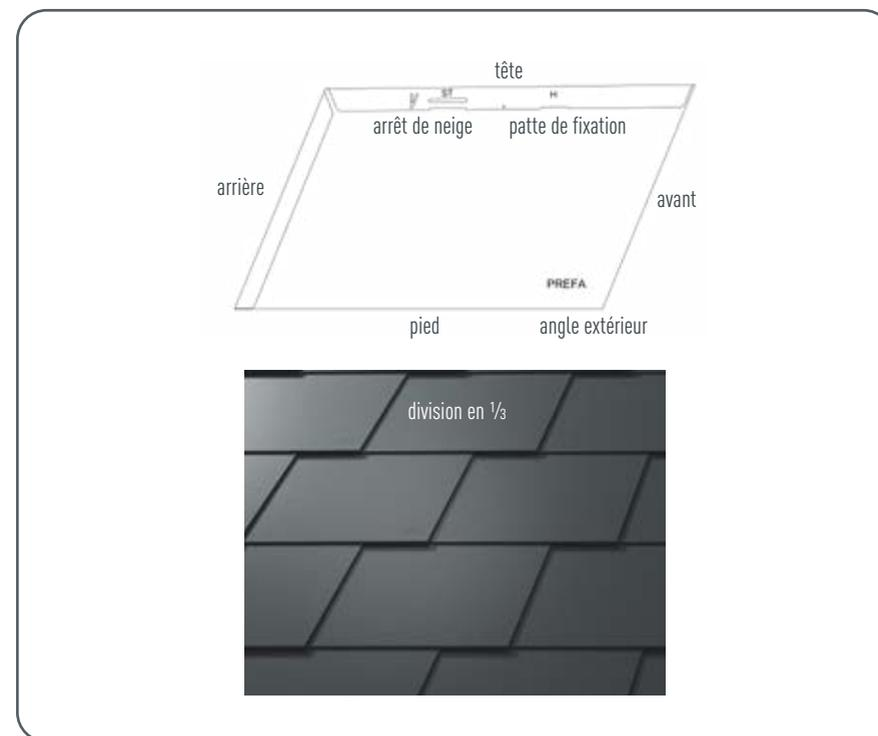
Figure 25 • Bardeaux – Sens de couverture et fixation
