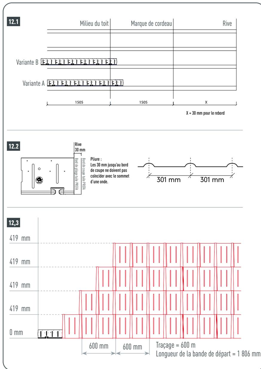
Figure 12 • Cotes de tracé pour les tuiles
