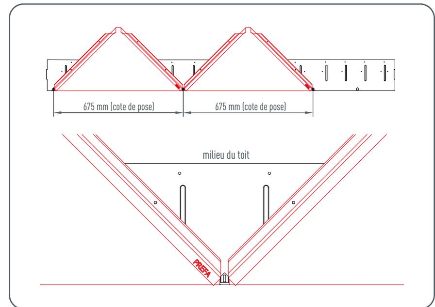
Figure 58 • Particularité pour les losanges de toiture 44 x 44
