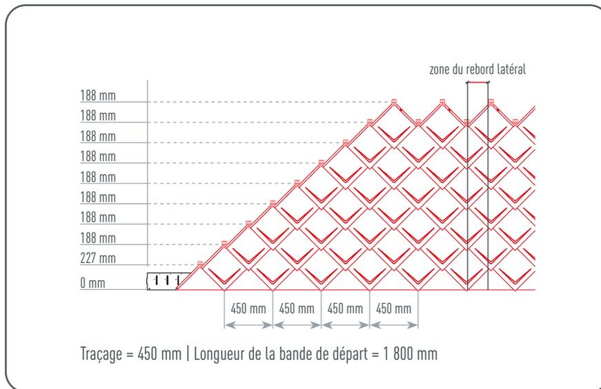
Figure 34 · Cotes de traçage pour les losanges de toiture 29 × 29
