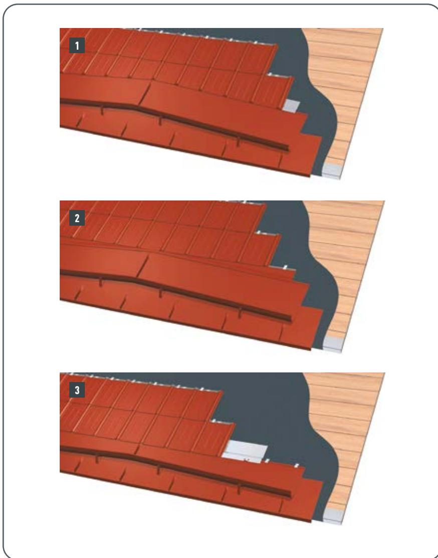
Figure 76 • Raccordement à une gouttière havraise
