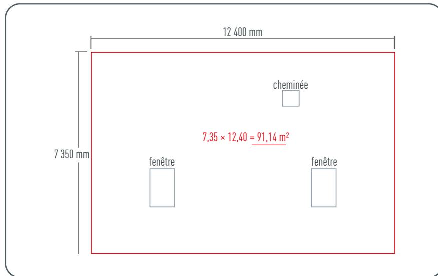
Figure 45 - Exemple de détermination des quantités de FX.12
