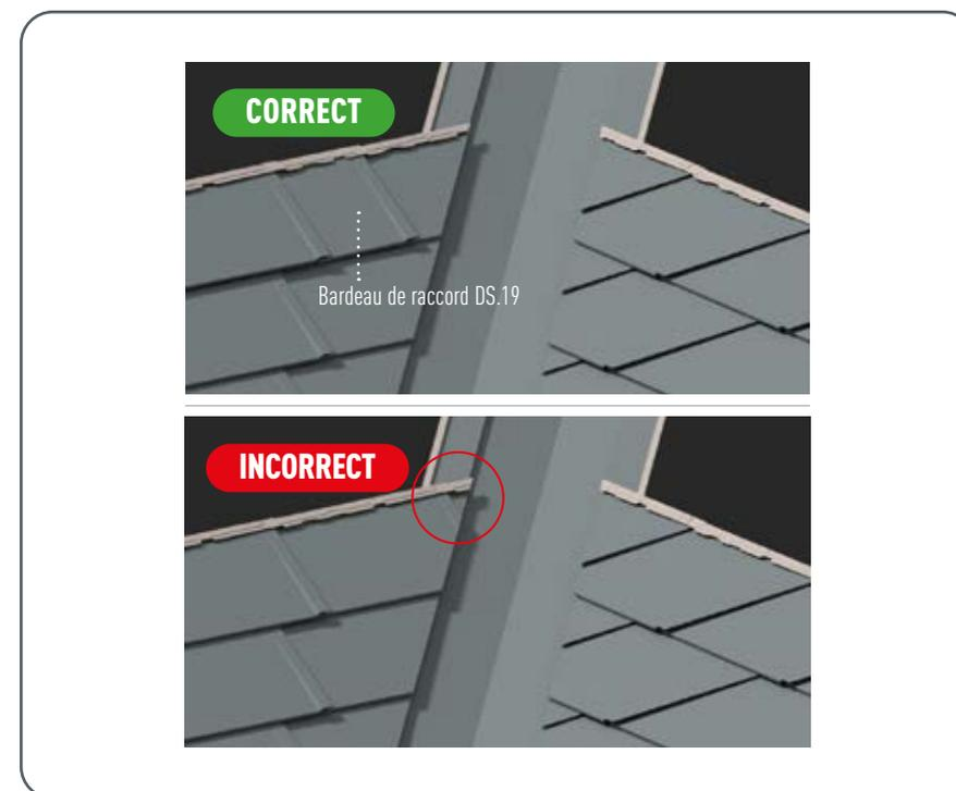
Figure 63 • Réalisation de la noue – Particularité pour les bardeaux DS.19
