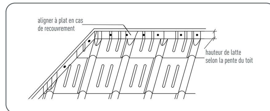
Figure 66 • Faîte et arête avec faîtière et arêtier
