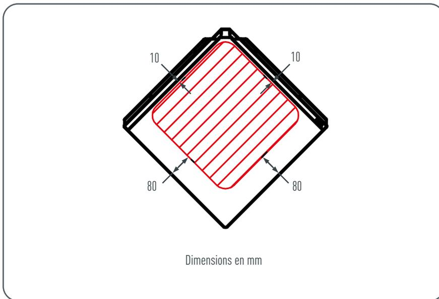
Figure 41 • Losange de toiture 44 x 44 – Zone de montage
