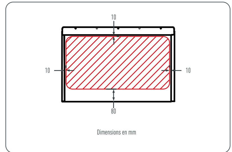
Figure 50 • Panneau de toiture FX.12 – Zone de montage
