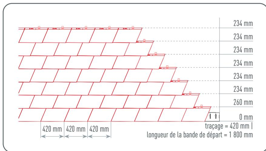
Figure 24 • Bardeaux – cotes de traçage horizontales
