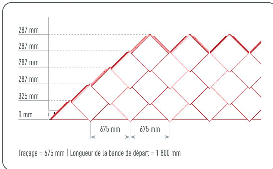
Figure 39 • Cotes de traçage pour les losanges de toiture 44 x 44
