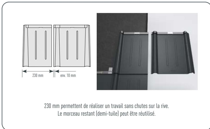
Figure 11 • Tracé pour les tuiles
