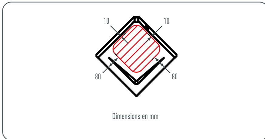
Figure 37 • Losange de toiture 29 x 29 – Zone de montage
