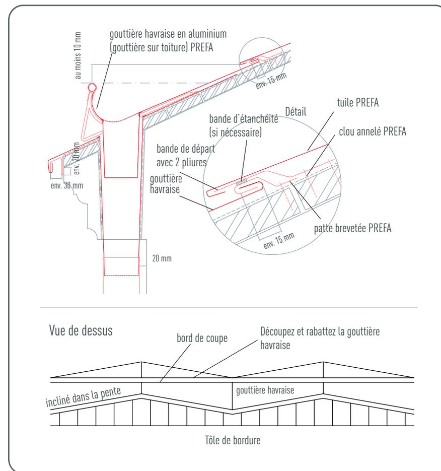
Figure 77 • Raccordement à une gouttière havraise
