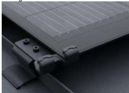
Fixation avec pince centrale/d'extrémité solaire **PREFALZ 500/650** sur double joint debout avec protection antichute de module. Le nombre de pinces par panneau varie en fonction de la pente du toit et de son emplacement (voir étude de montage).
