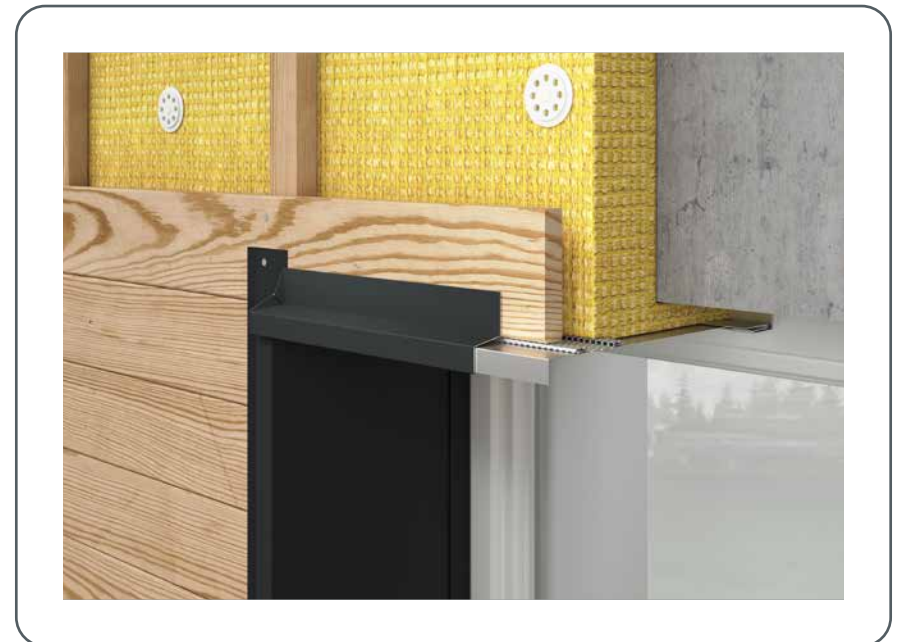
Abbildung 80 · Montage Wetterschenkel Fenstersturz
