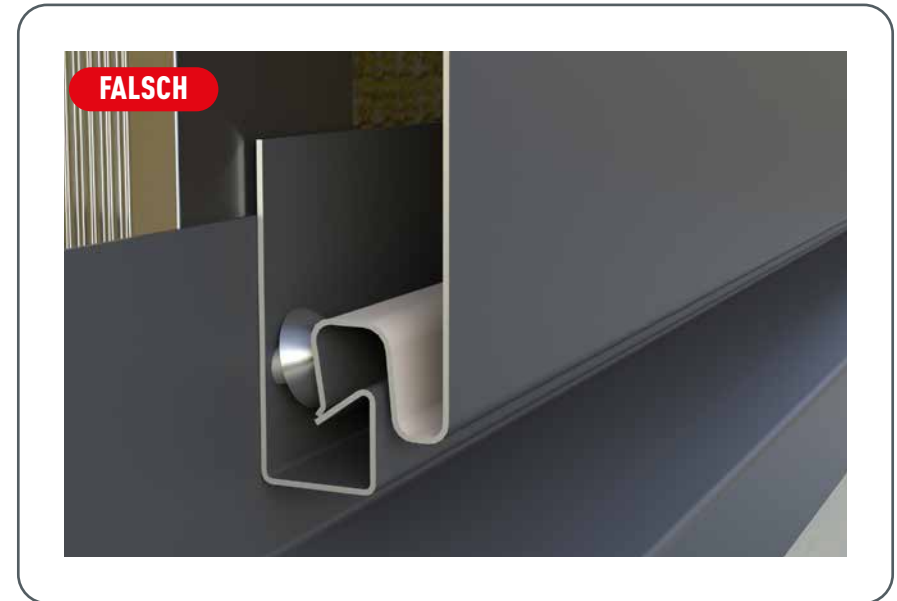
Abbildung 77 • Befestigung Startprofil nicht in Ordnung
